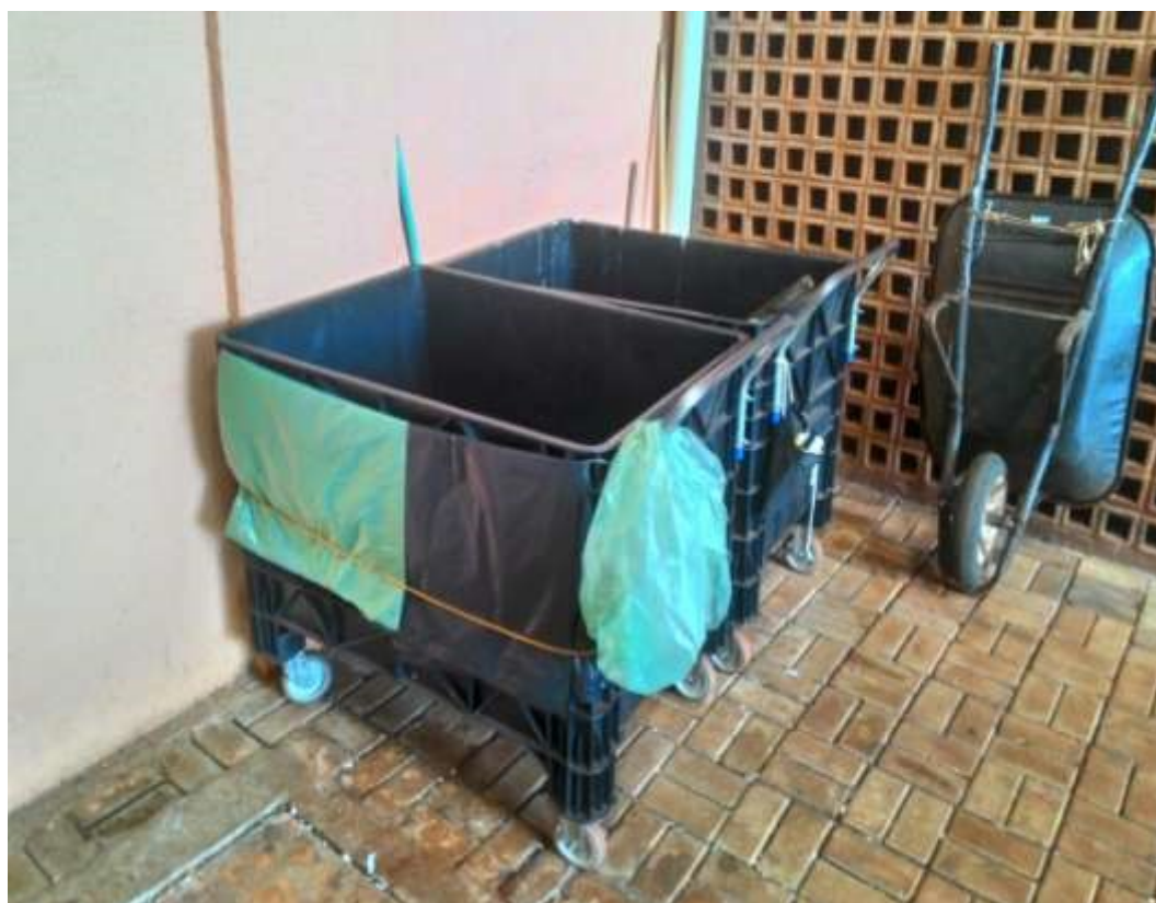
Figura 14: Contêiner de PEAD, com 4 rodas, utilizado para o transporte interno de resíduos até as ATTs.
