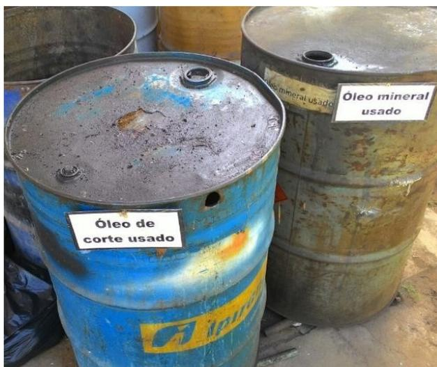
Figura 05 (DAMEC). Acondicionamento dos resíduos perigosos (CLASSE I) e resíduos não-inertes (CLASSE IIA)
