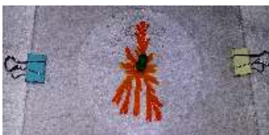
Figura 2.7: Distribuição do corante na Célula de Hele- Shaw
